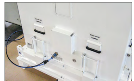
Waterdampdichte laadcontainer bij de beproeving op dichtheid onder overdruk
