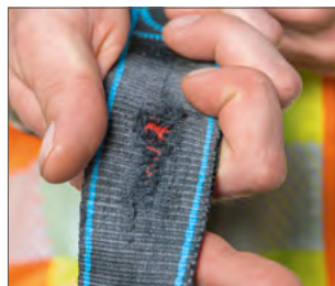
WebAlert™ detecteert onmiddellijk elke slijtage.
